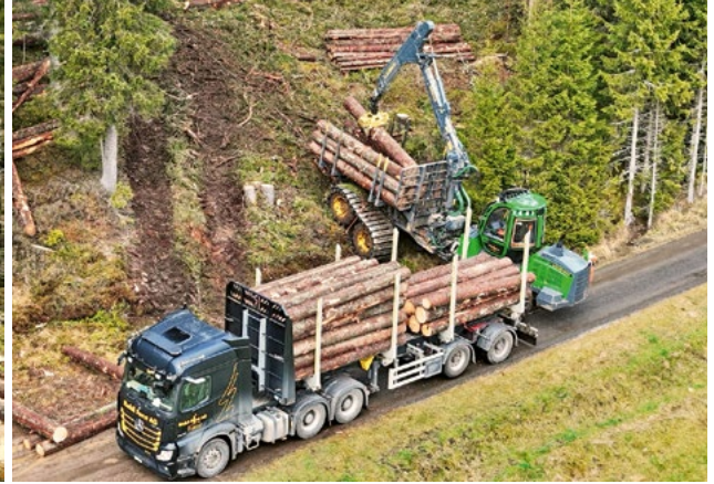
Direktverlad auf LKW mit Forwarder (Fotos: Riebli Forst AG)
